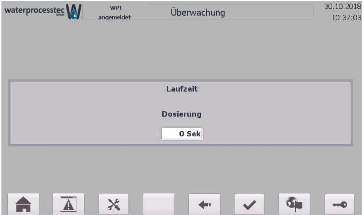
Hier wird die Überwachungszeit für den Motorkugelhahn eingestellt.
