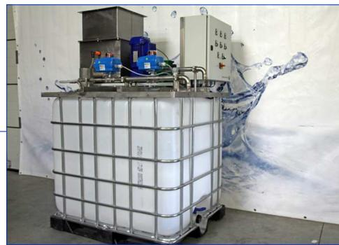
Im Ansatzbehälter wird durch die Wasserschnellbefüllung eine Wasservorlage bis zur Benetzung der Rührwerke eingebracht. **Der Füllstand** wird hierzu kontinuierlich gemessen. Über einen Trockengutdosierer wird dann die notwendige Menge an Polymer dosiert. Die Konzentration hierfür kann in der Steuerung hinterlegt werden.
