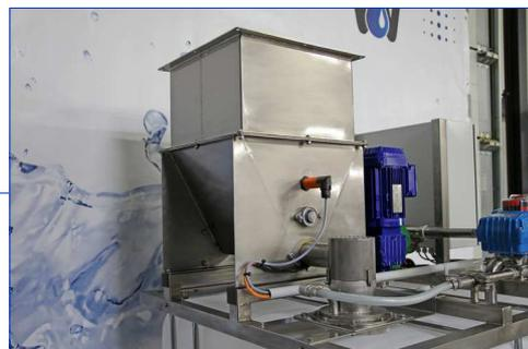
Über die Austragsschnecke des Trockengutdosierers erfolgt der Pulvertransport in den **innovativen Mischkopf**. Bereits hier erfolgt eine Benetzung mit Wasser. Durch die frühzeitige Vermischung wird eine Klumpenbildung auf der Wasseroberfläche verhindert. Das so in Lösung gebrachte Produkt wird durch ein Rührwerk äußerst schonend weiter vermischt, bis die optimale Reifezeit abgelaufen ist.
